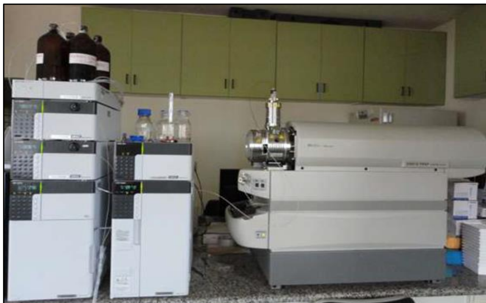
Figura 4. Cromatógrafo Líquido (Prominence UFLC) acoplado ao espectrômetro de massas (3200 Q TRAP) – LC-MS/MS.
