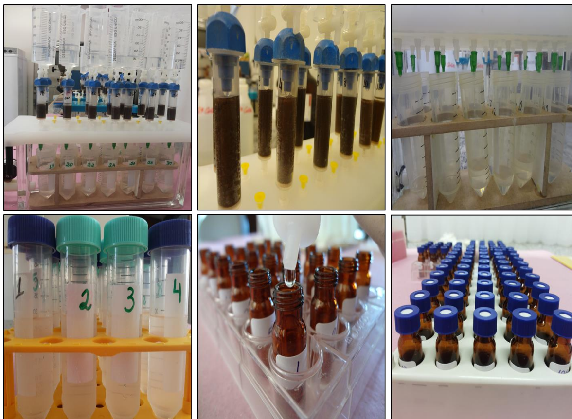
Figura 3. Extração da solução do solo por meio de solução extratora e preparo das amostras para a quantificação dos herbicidas por cromatografia líquida de alta performance (HPLC) e espectrometria de massas.
