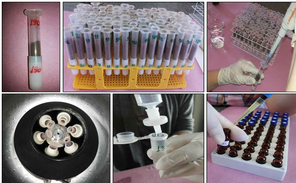
Figura 2. Saturação dos solos nos cartuchos com água destilada, água de palhada e vinhaça, para a extração da solução e o preparo das amostras para quantificação dos herbicidas por cromatografia líquida de alta performance (HPLC) e espectrometria de massas.
