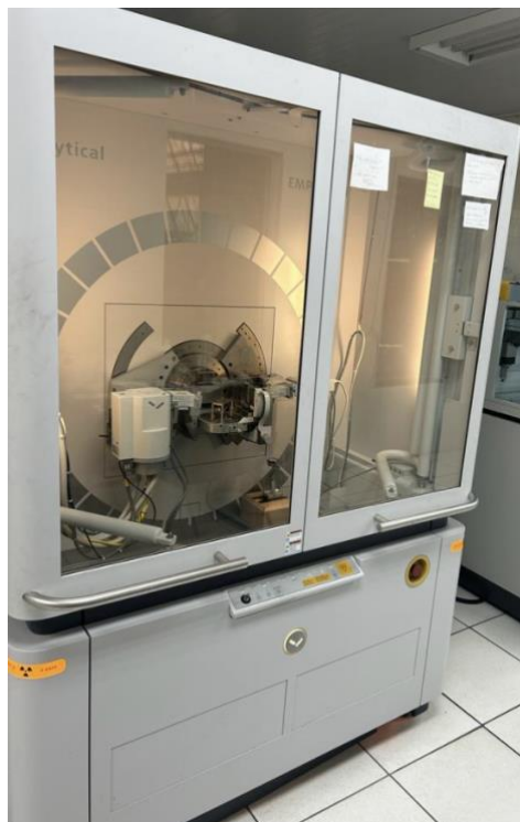
Figura 9 – Máquina Empyrean de ensaios de difratometria de raio-X (DRX).
