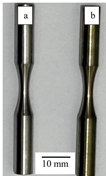
Figura 14 – (a) Liga Ti-6Al-4V sem ensaio de oxidação isotérmica (b) comparado com a amostra submetida ao ensaio de oxidação isotérmica, na temperatura de 350°C.
