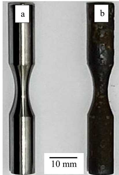
Figura 15 – (a) Liga Ti-6Al-4V sem ensaio de oxidação isotérmica (b) comparado com a amostra submetida ao ensaio de oxidação isotérmica, na temperatura de 650°C.
