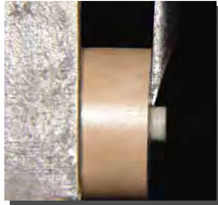
FIGURA 6 – Teste de resistência ao cisalhamento.
