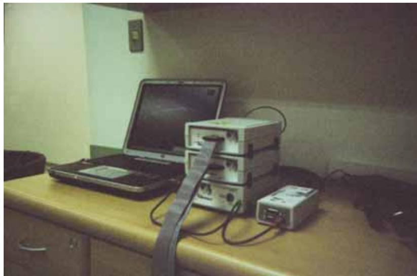
**Figura 6: Equipamento de EEG.** *BrainProducts BrainAmp MR Plus* e *BrainProducts Powerpack*, ligados a computador de recepção de sinal, através de conversor óptico-USB também *BrainProducts*.
