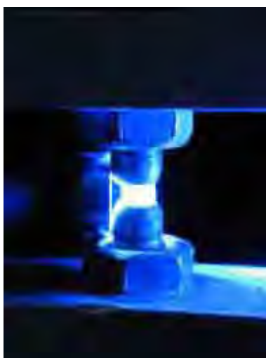
Figura 18 - Fotopolimerização de incremento de 2mm de espessura entre as duas bases rígidas.
