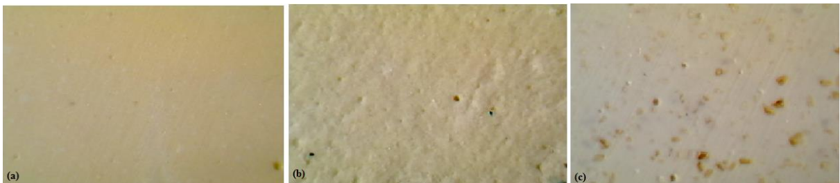
Figura 1 (a,b,c): Aspecto da porosidade dos cimentos AHP (a),MTAF (b) e EDF (c) em aumento de 50 vezes observados em microscópio digital invertido.
