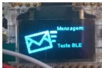
Figura 57 – Valor da característica MSG atualizado na tela do display OLED
