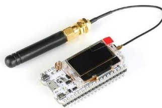
Figura 9 – Módulo ESP32-LoRa com Display Oled (LCD)
