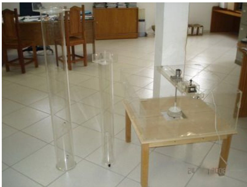
Figura 4.9 – Conjunto completo da ETE Piloto, com aerador, decantador e adensador.
