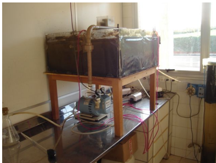
Figura 5.5 – Tanque de aeração e decantador envolvidos por plástico escuro
