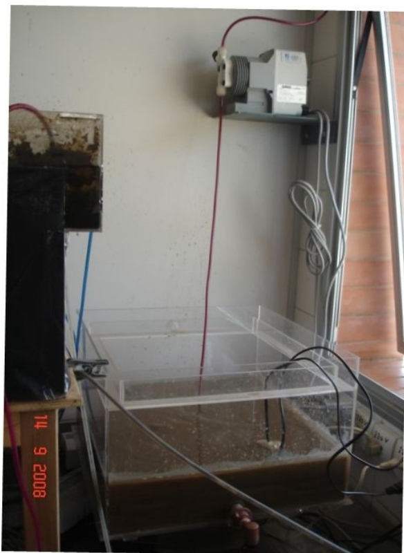
Figura 4.15 – Sistema para a aplicação do lodo de ETA
