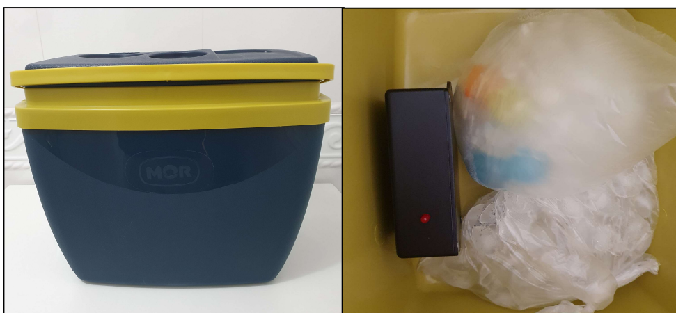
Figura 13. Imagem ilustrativa de uma caixa térmica de transporte e do dispositivo acondicionado em seu interior, juntamente com amostras biológicas para testagem de sua funcionalidade.
