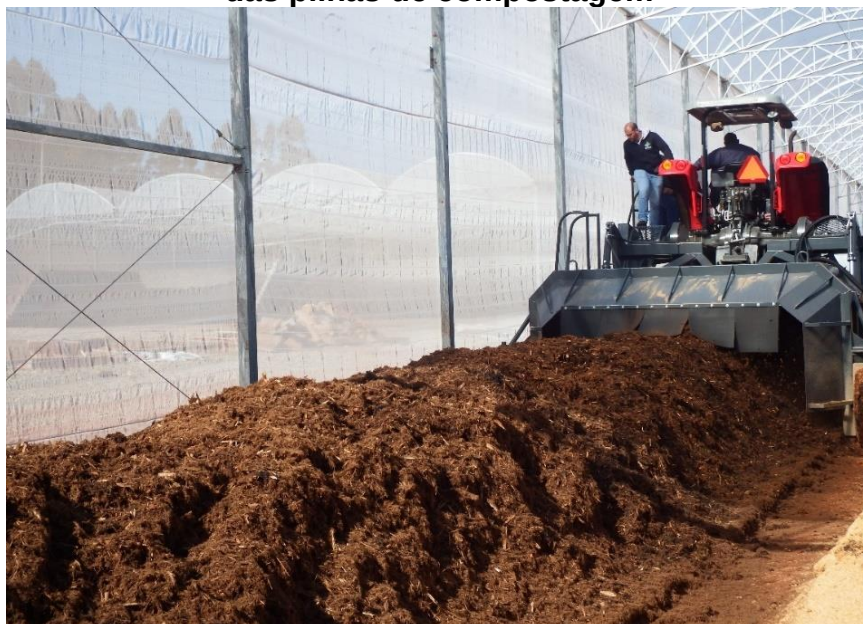
Figura 5 – Máquina compostadora realizando a mistura do material em uma das pilhas de compostagem
