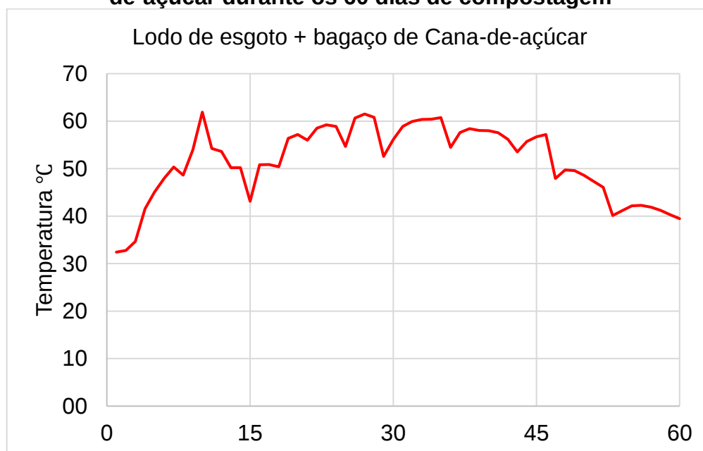
Figura 24 – Temperatura média da pilha com lodo de esgoto e bagaço de cana-de-açúcar durante os 60 dias de compostagem
