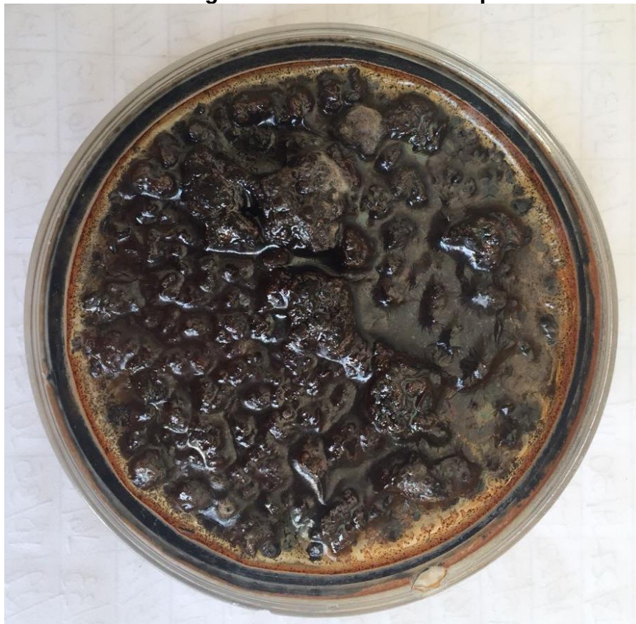
Figura 31 – Placa de Petri com amostra de lodo de esgoto reidratada a 70% de umidade e submetida a 42^{\circ}\text{C} \pm 2^{\circ}\text{C} em estufa, por período de sete dias. Detalhe para coloração ferrugem nas laterais da Placa de Petri e formação de algumas placas bacterianas/fúngicas acinzentadas na superfície do material
