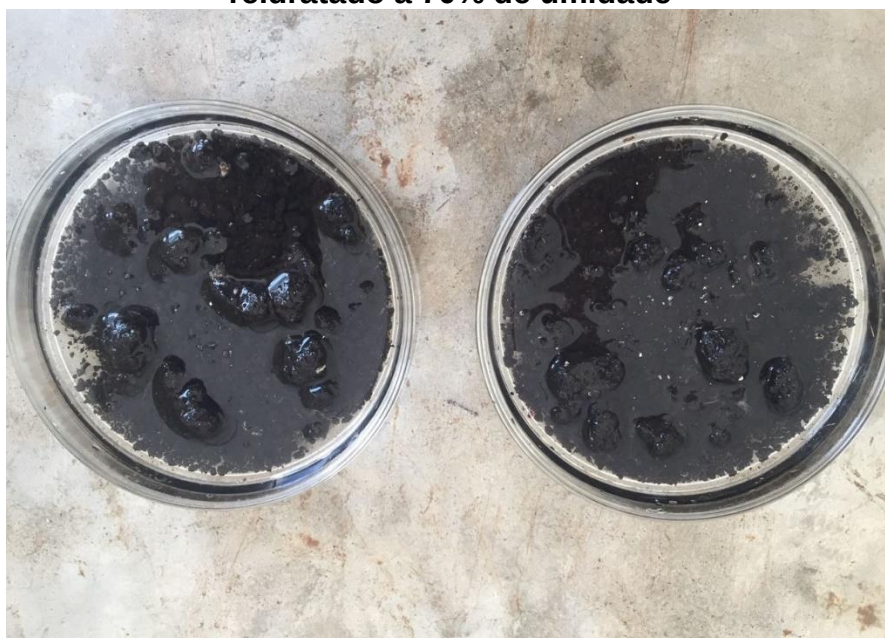
Figura 11 - Placas de Petri contendo amostras de lodo de esgoto sanitário reidratado a 70% de umidade
