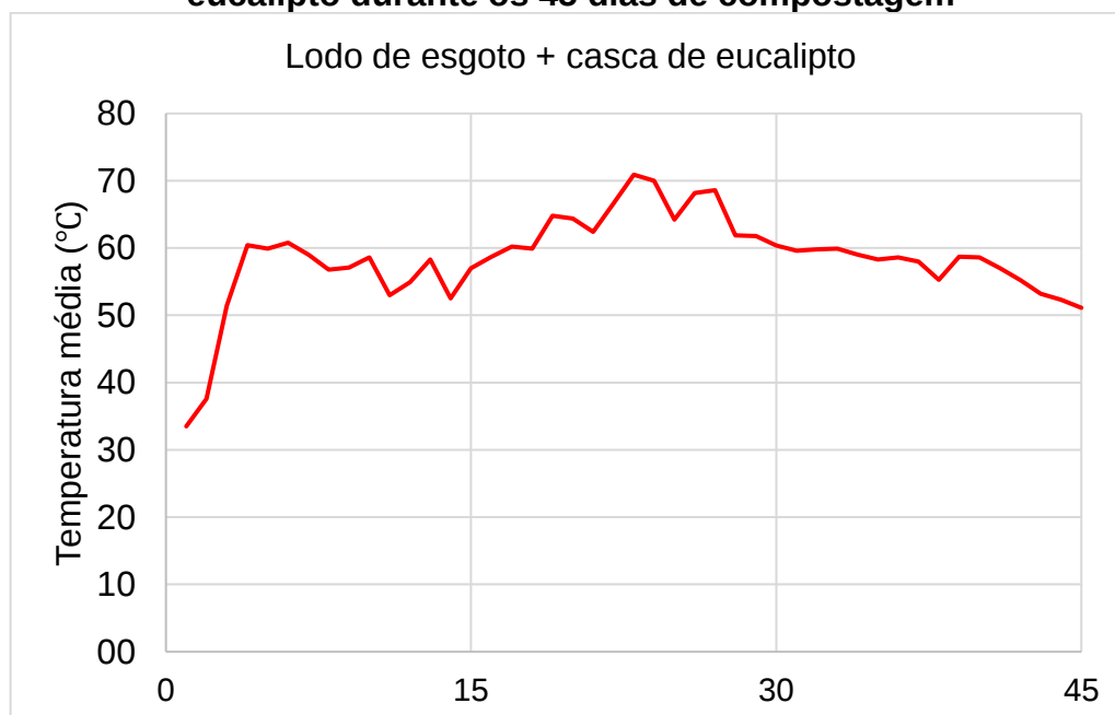
Figura 25 – Temperatura média da pilha com lodo de esgoto e casca de eucalipto durante os 45 dias de compostagem
