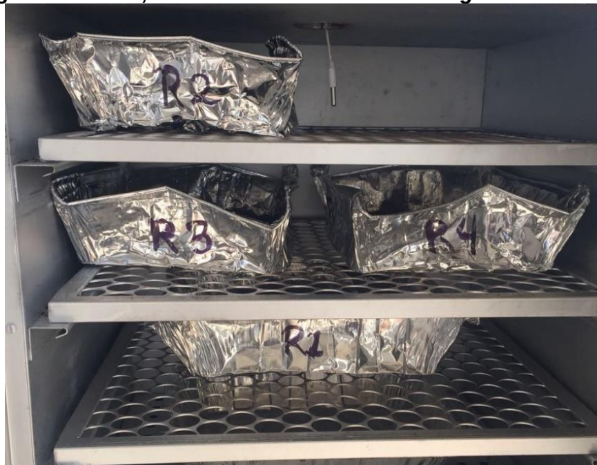
Figura 10 – Bandejas descartáveis de alumínio contendo amostras de lodo de esgoto sanitário, incubadas em estufa de secagem a 42^{\circ}\text{C} \pm 2^{\circ}\text{C}
