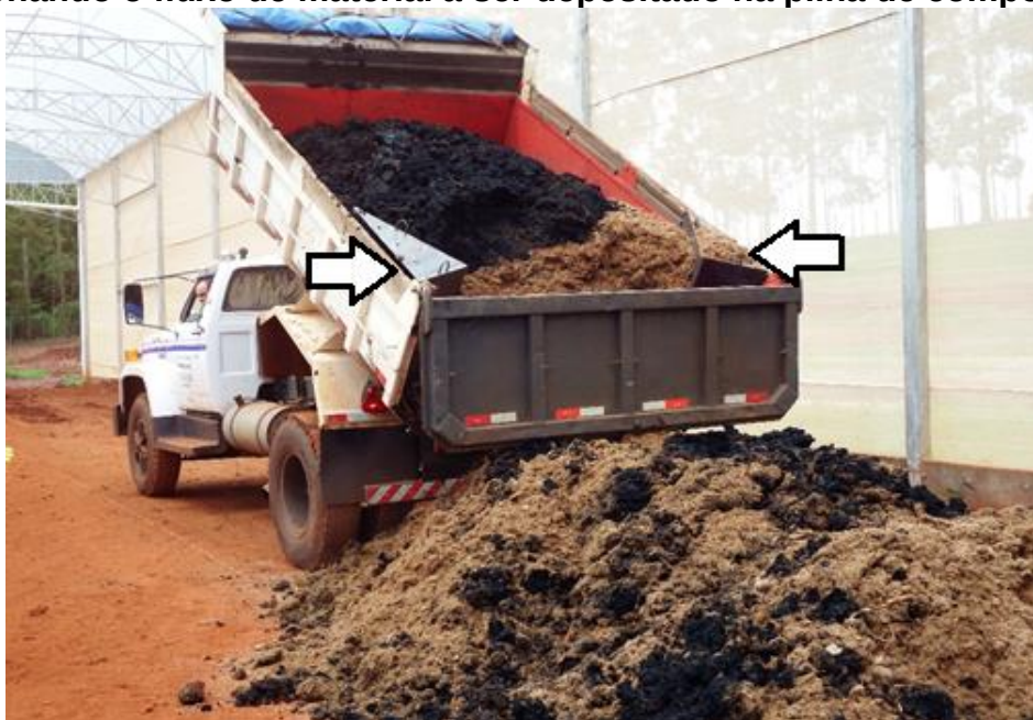
Figura 9 – Estruturas de metal instaladas na saída do caminhão basculante, direcionando o fluxo de material a ser depositado na pilha de compostagem
