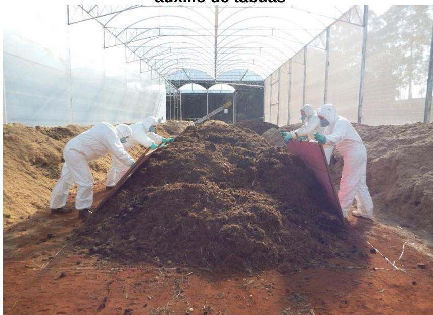
Figura 6 – Ajuste manual da largura (3m) de uma pilha de compostagem, com o auxílio de tábuas
