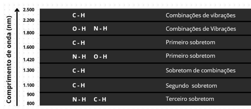
Figura 14 - Comprimento de onda aproximado dos achados espectrais ocasionado pela absorção da radiação no infravermelho próximo por grupos funcionais CH, OH e NH.
