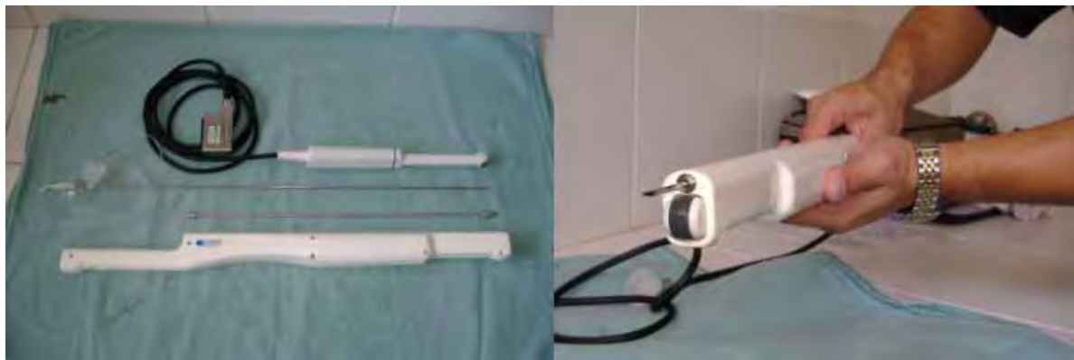
Figura 15: Transdutor e guia de aspiração utilizada no experimento.
