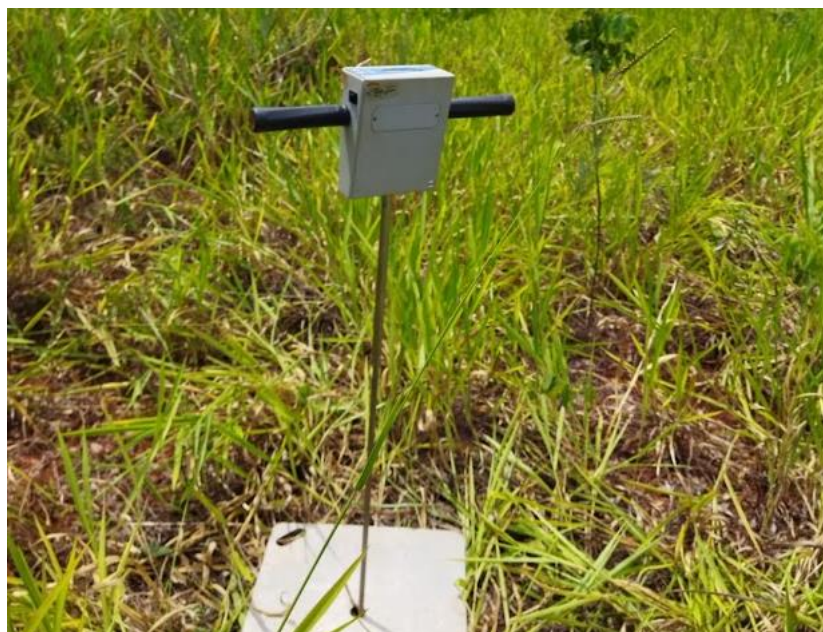
Figura 4: Penetrolog – Fonte: Figueredo, 2022.
