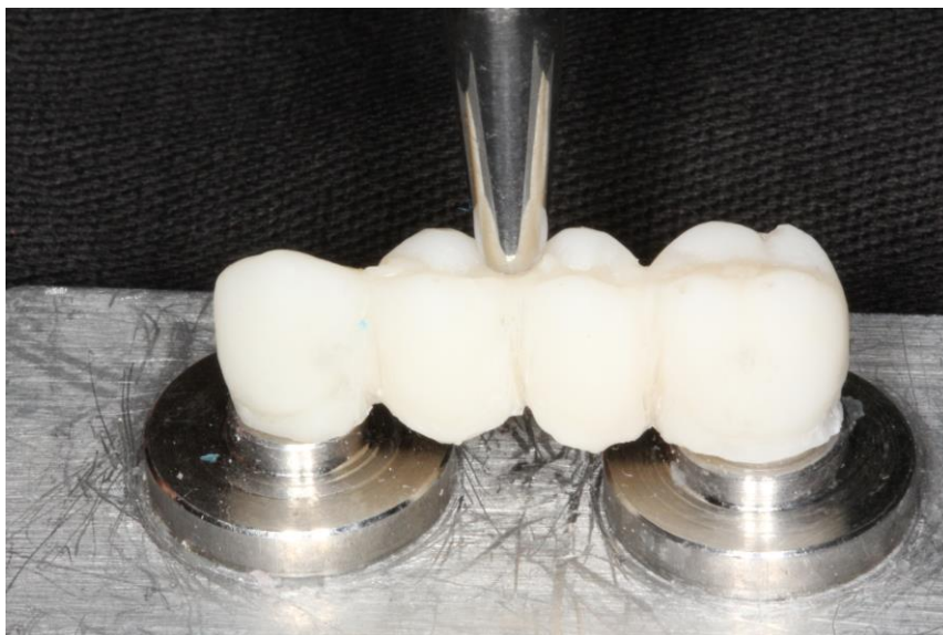
Figura 15 – Posicionamento da ponta metálica no corpo de prova para realização de teste de fratura.
