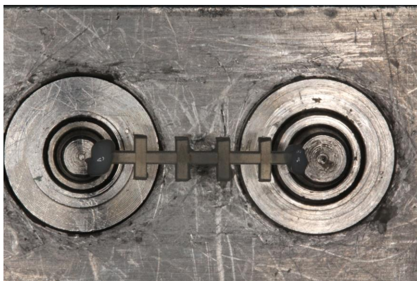
Figura 12 – Modelo com reforço na posição horizontal.
