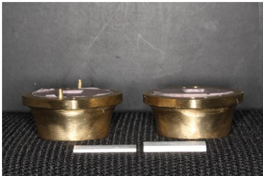
Figura 17 – Barras metálicas e mufla ocular que foram utilizadas para confecção da matriz de silicone.
