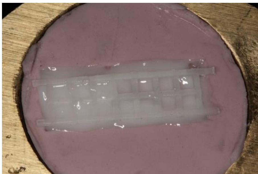
Figura 19 – Posicionamento da malha no momento da confecção do corpo de prova.
