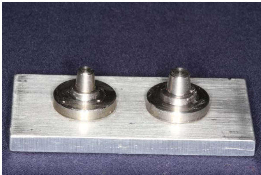
Figura 1 – Matriz metálica em aço temperado.
