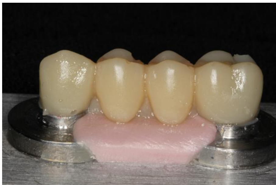
Figura 14 – Vista vestibular do corpo de prova posicionado no dispositivo logo após sua confecção.
