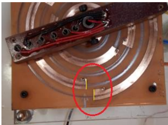
Figura 31 – Detalhe da transição entre uma escova e outra.
