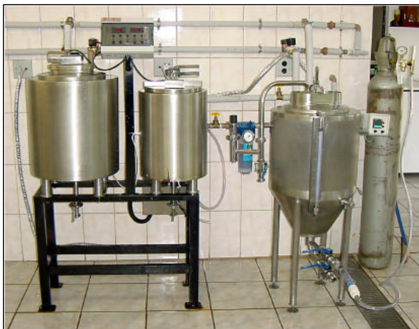
Figura 5: Planta piloto para a produção de refrigerantes. No centro, tanque de produção de xarope simples; à esquerda, preparo e resfriamento do xarope composto e à direita, carbonatação.
