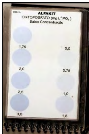
Fig. 05 - Cartela colorimétrica para medir Ortofosfato
