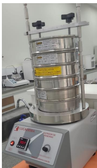
Figura 4 - Agitador de peneiras para análise granulométrica
