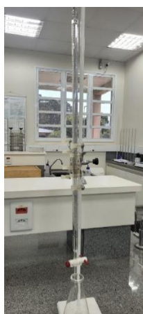
Figura 8 - Aparelhagem empregada na determinação do índice de acidez
