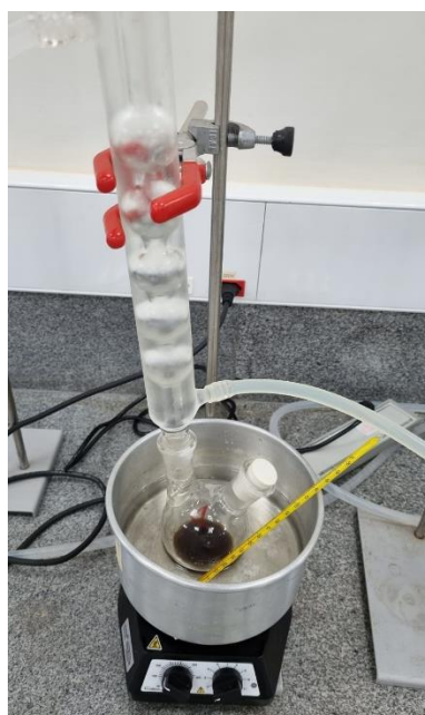
Figura 11 - Reator batelada para produção de biodiesel
