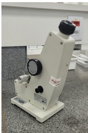
Figura 9 - Instrumento de medição de índice de refração: Refratômetro ABBE AR 1000 S
