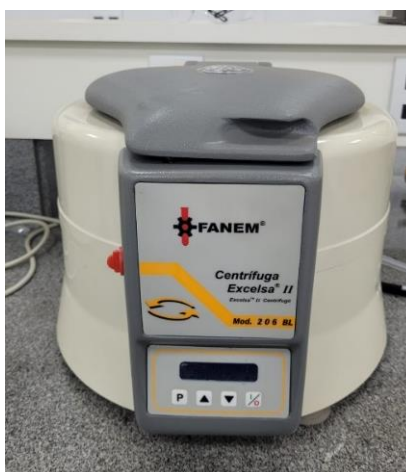
Figura 13 - Separação de glicerina e biodiesel por centrifugação
