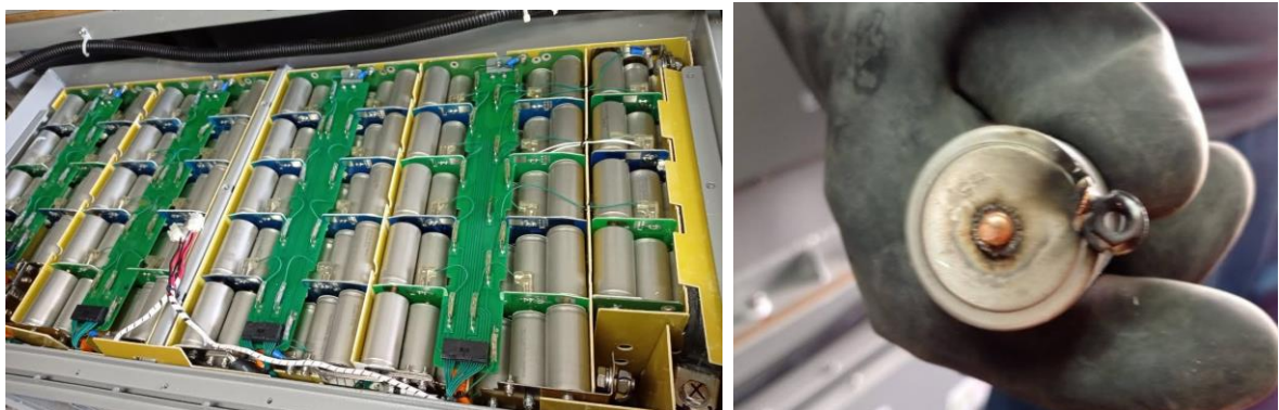
Figura 31- Pack de Bateria Aberto/Célula danificada
