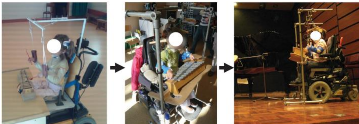
Figura 14 - Evolução do dispositivo auxiliar para a prática do xilofone até o produto final.
