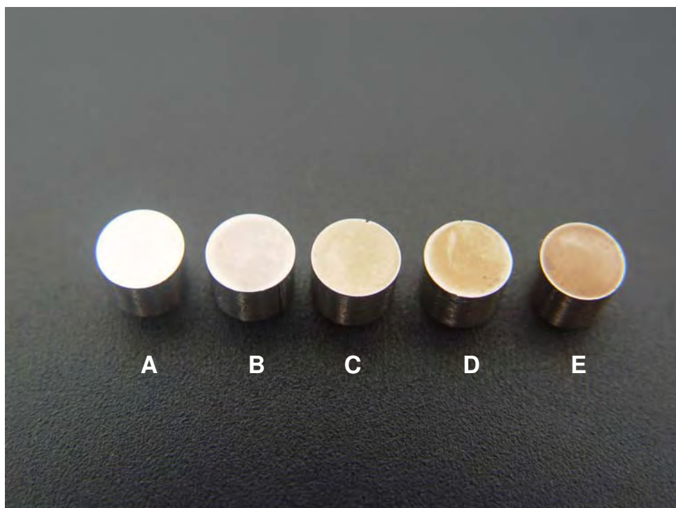
FIGURA 8 – Imagem macroscópica de uma amostra representativa de cada grupo mostrando perda gradativa do brilho e presença de manchas nas amostras B (G5), C (G10), D (G15) e E (G20). Amostra A (G0) apresenta superfície espelhada.
