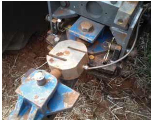
Figura 8. Célula de carga utilizada.
