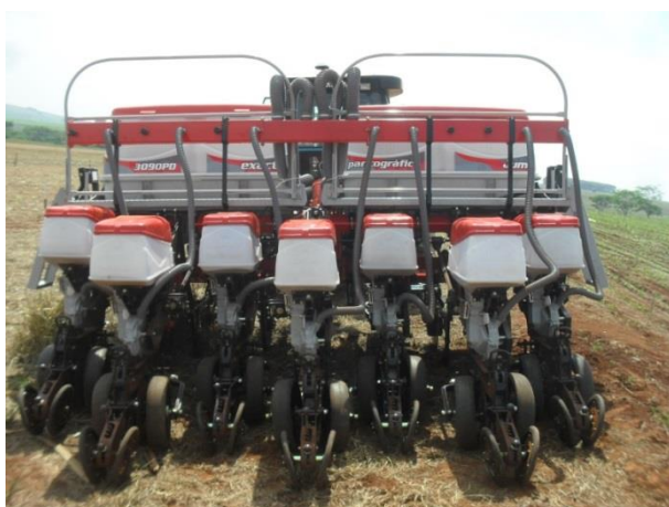
Figura 5. Semeadora-adubadora (A) e monitor de plantio (B).
