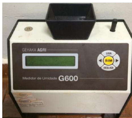
Figura 5. Medidor de teor de água dos grãos de soja.
