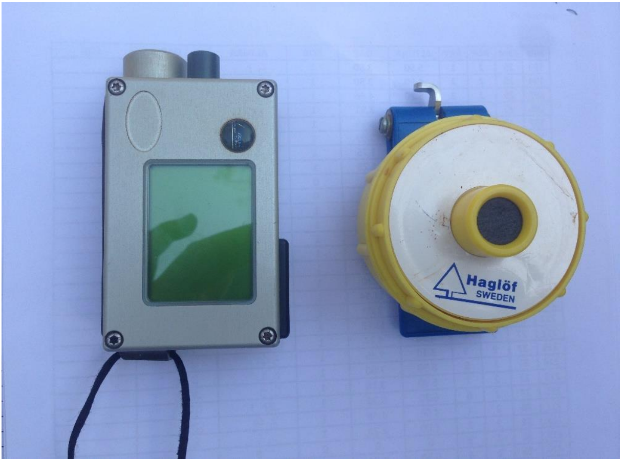
Figura 5: Hipsômetro modelo Vertex IV baseado em sistema ultrassom para medição da altura das árvores (Fonte: Santos, 2018)
