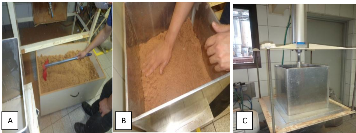
Figura 15. Retirada das fibras da encoladeira (A), acondicionamento de forma uniforme no dispositivo da pré-prensa (B), e a pré-prensagem pelo cilindro pneumático (C) (Fonte: Autor).
