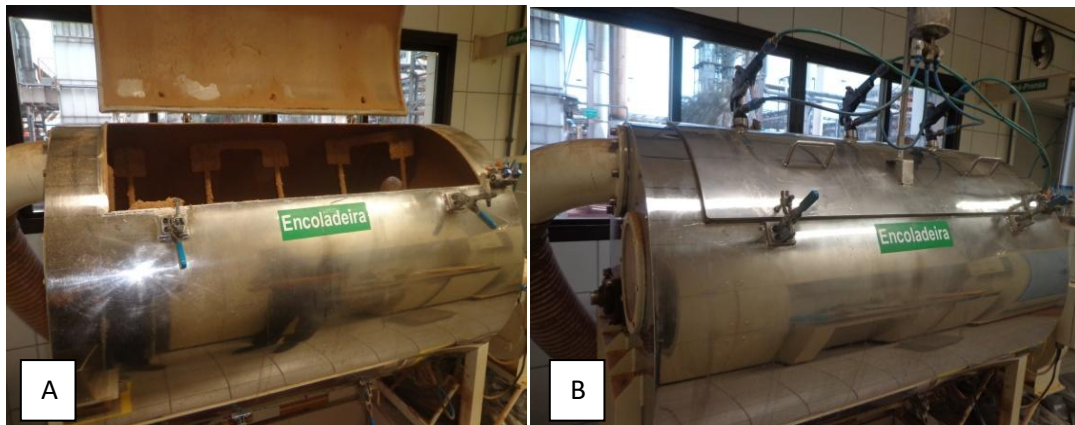
Figura 14. Processo de encolagem das fibras com os adesivos e aditivos – vista interna da encoladeira (A), vista geral da encoladeira com o sistema de aspersão (B) (Fonte: Autor).
