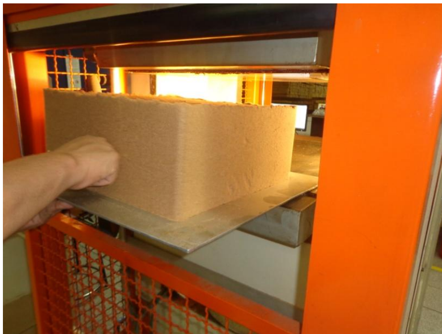
Figura 17. Colchão de fibras encoladas sendo posicionado na prensa (Fonte: Autor).
