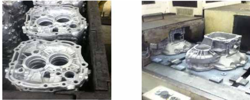
Figura 48 - Placa de rolamento (esq) e carcaça da transmissão (dir). Componentes usinados (GM-SJC)
