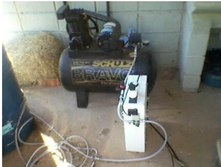
Figura 4 – Compressor de ar utilizado na compostagem mecanizada
