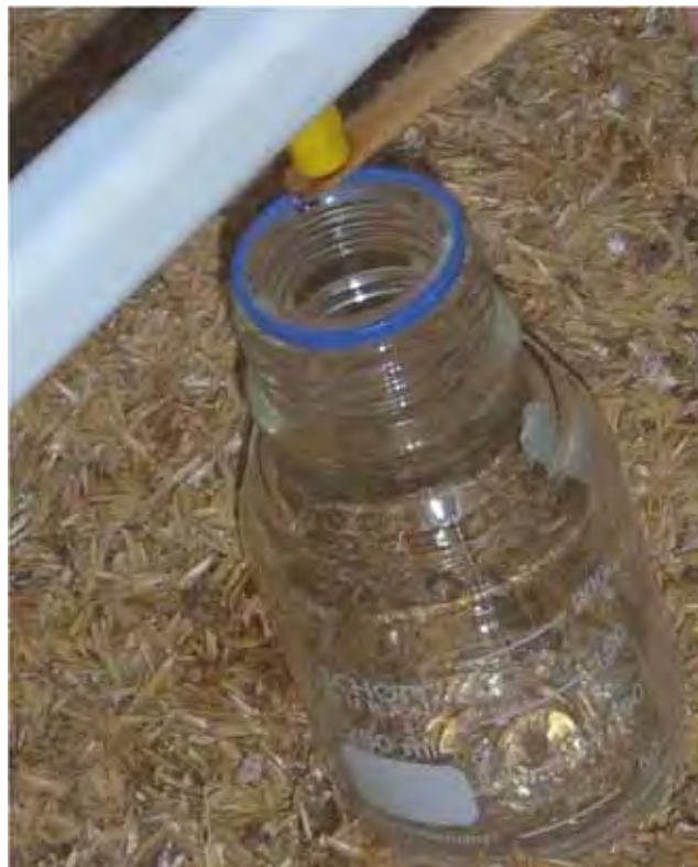
Figura 3. Coleta semanal de amostras de água no bico de bebedouros tipo nipple utilizando espátula de madeira estéril adaptada momentaneamente.
