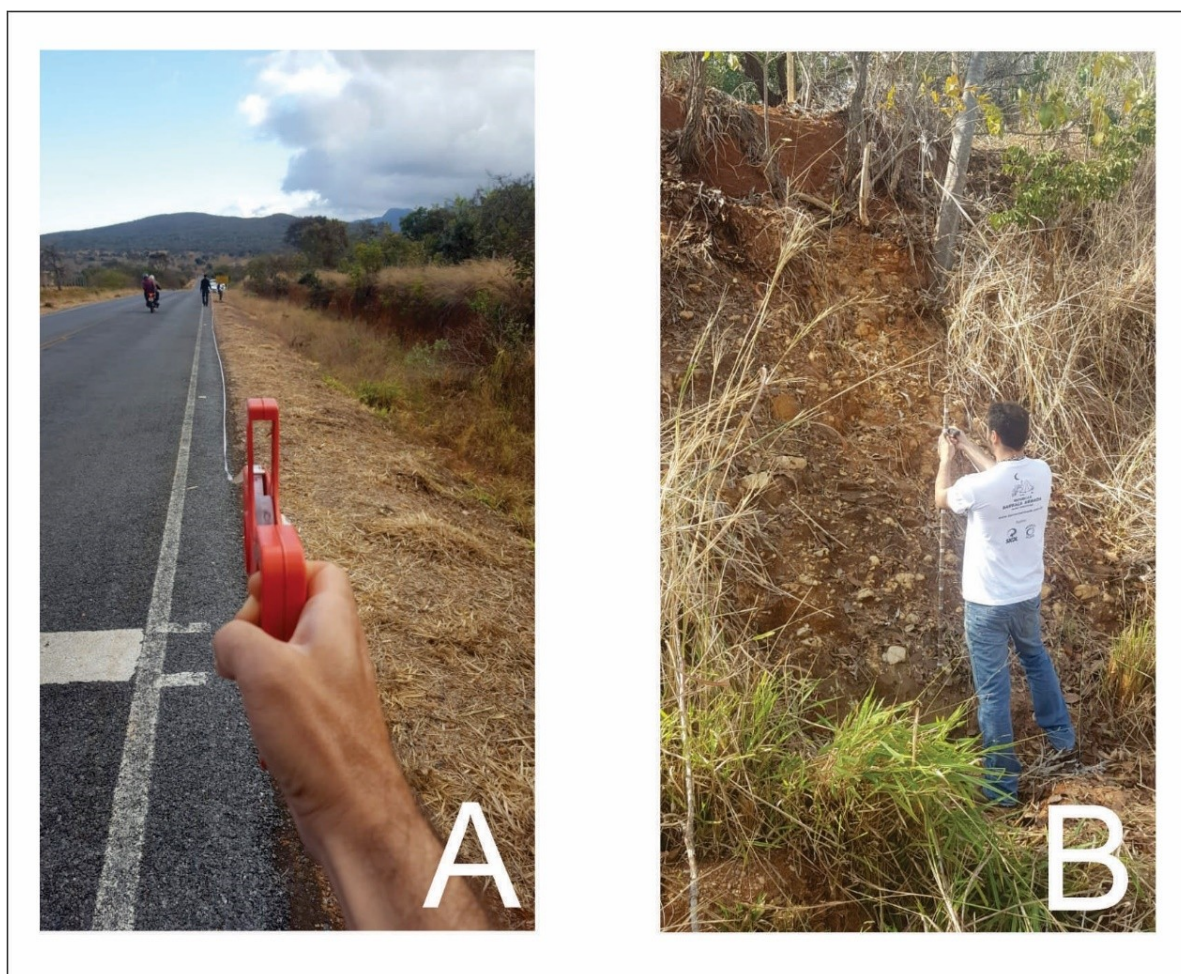
Figura 4.1: Medições dos depósitos em campo. A) Medição do comprimento do depósito. B) Medição da altura do depósito com o uso da vara de Jacó.
