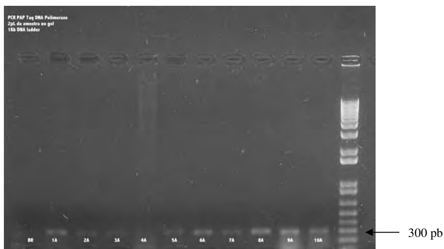
Figura 6. Eletroforese em gel de agarose a 1% dos produtos de PCR da fosfatase ácida prostática (PAP) do grupo A, utilizando a Platinum DNA Taq polimerase™ (Invitrogen). Observar tamanho da banda medida pelo marcador (Kb) em cerca de 300 pares de base.
