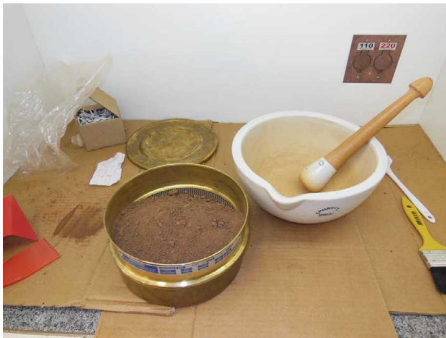
Figura 10: Processo de desagregação mecânica.
