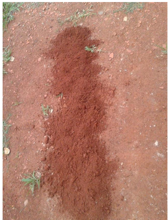
Figura 8: Tradagens de amostras de solos e observação dos perfis até a profundidade de 1,50 m. Fonte: Registrada pelo autor.
