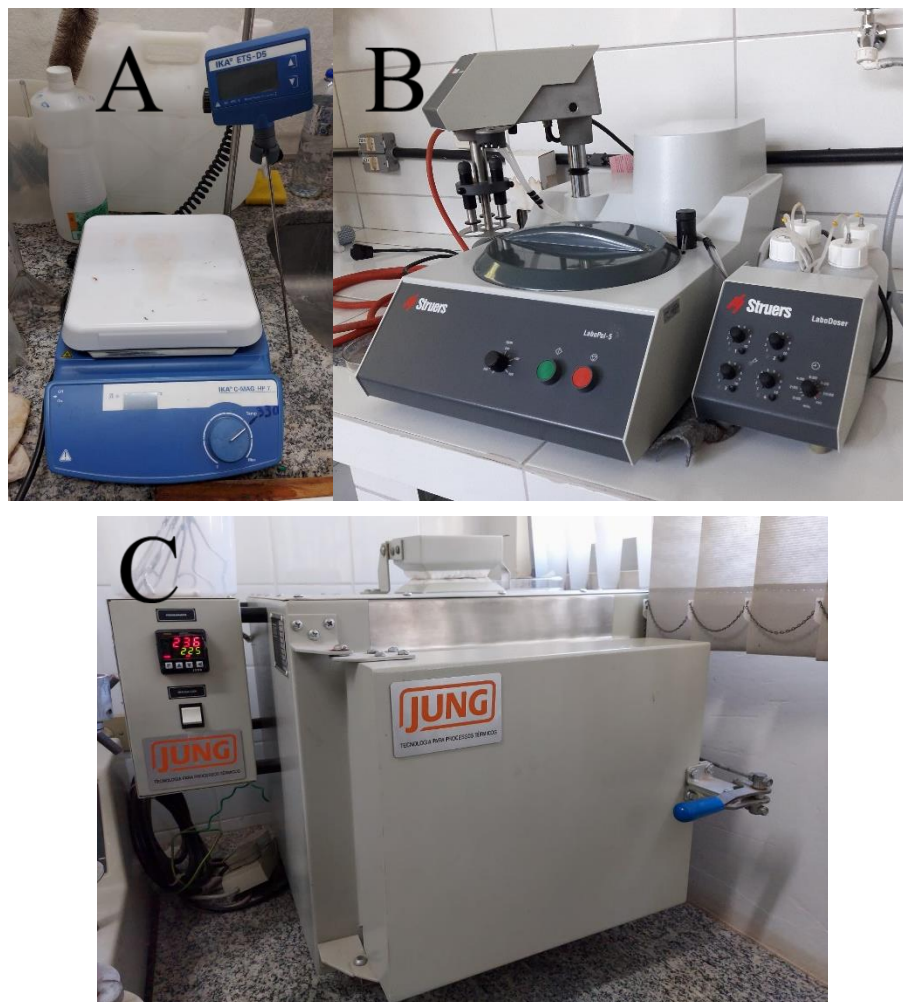
Figura 15 – Equipamentos de montagem do zircão: (A) chapa térmica, (B) politriz, (C) forno elétrico
