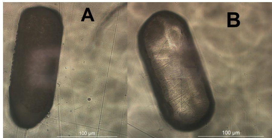
Figura 45 – Micrografias por luz transmitida e aumento nominal de 500x em: (A) grão anômalo com superfície destruída, (B) superfície intacta
