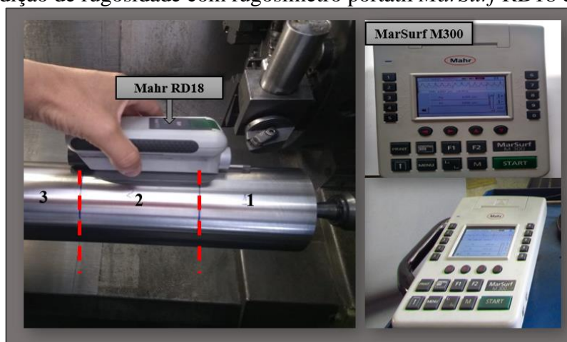
Figura 34 – Medição de rugosidade com rugosímetro portátil MarSurf RD18 e MarSurf M300.
