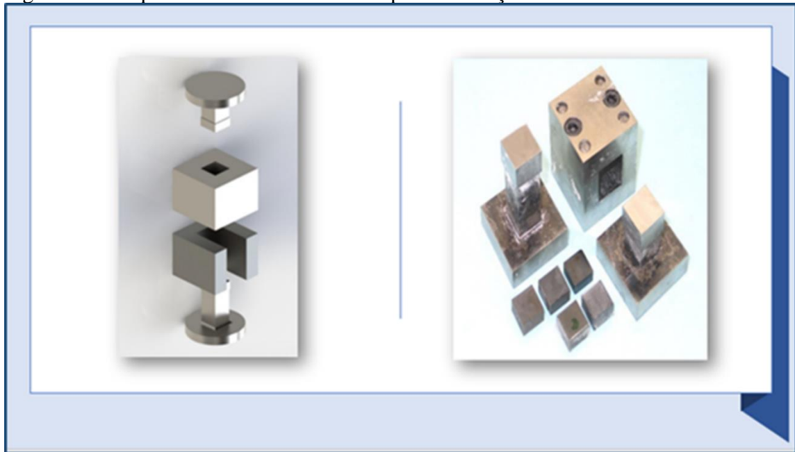
Figura 31 – Esquema 3D e molde metálico para fabricação das ferramentas cerâmicas.
