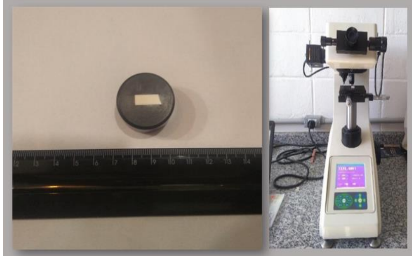
Figura 37 – Corpo de prova cerâmico embutido e microdurômetro Wilson Instruments .
