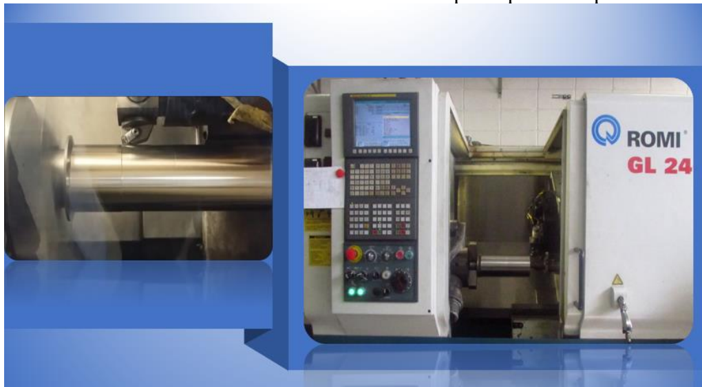
Figura 25 – Centro de Torneamento ROMI GL240M e corpo de prova acoplado na castanha.
