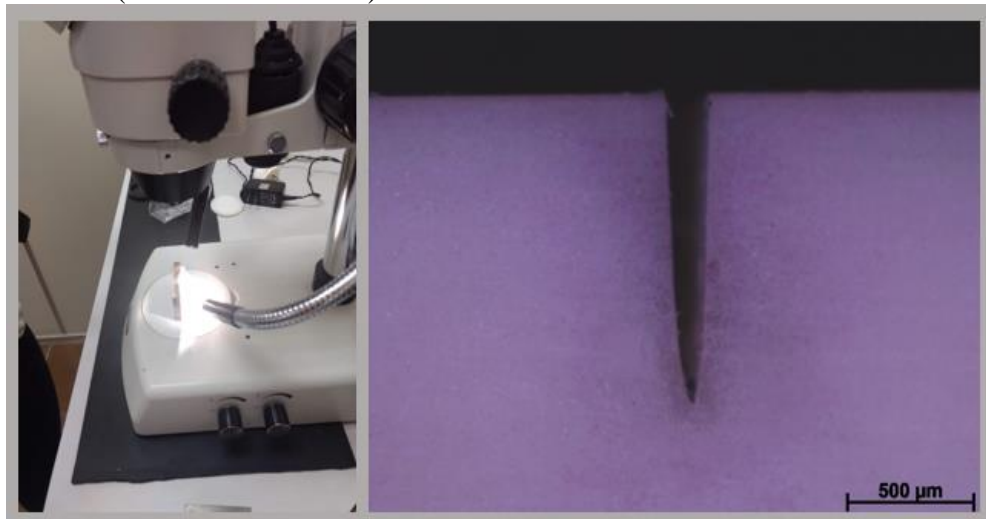
Figura 40 – Estereoscópio para verificação e medida do entalhe; Imagem do entalhe em estereoscópio Zeiss (Axion Cam ICC33).
