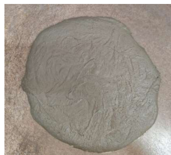
Figura 15 - Ensaio de espalhamento do UHPC
