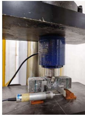
Figura 13 - Ensaio de flexão de 3 pontos com o sensor aplicado
