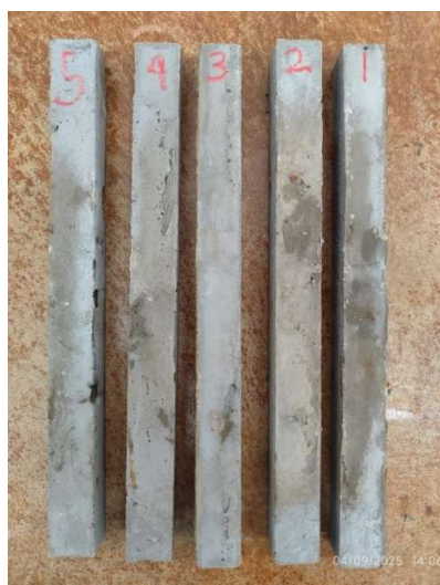
a) Amostras para ensaio de retração b) Dispositivo de ensaio
