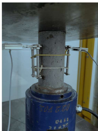
Figura 19 - Amostras cilíndricas de UHPC com microfibra de aço aos 28 dias de idade
