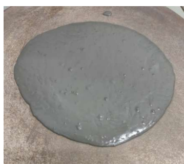
a) UHPC com microfibras de aço e 10% CCA
