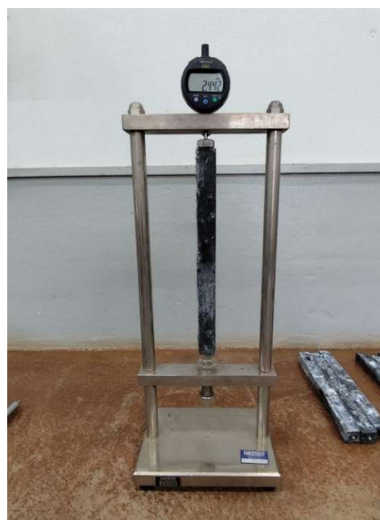
Figura 14 - Amostras de UHPC e equipamento para ensaio de retração
