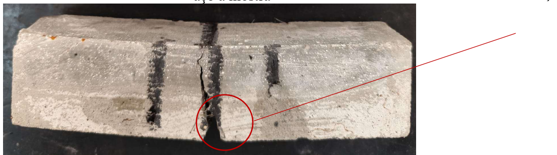
a) Primas 4x4x16 cm após ensaios de flexão com macrofibras de aço à mostra
