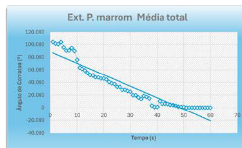
Figura 3. Ângulo de contato em função do tempo da manta EPM.
