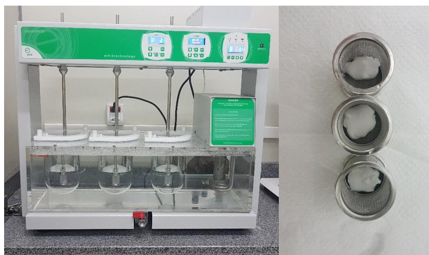
Figura 12: Dissolutor e aparelho USP tipo I com amostras
