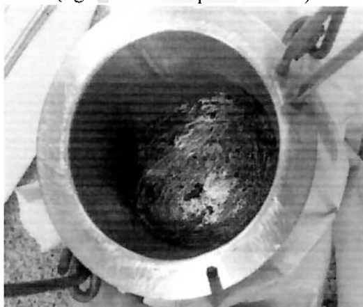
Figura 7: Fusão do composto (lignina de eucalipto e C_6H_8O_7 )
