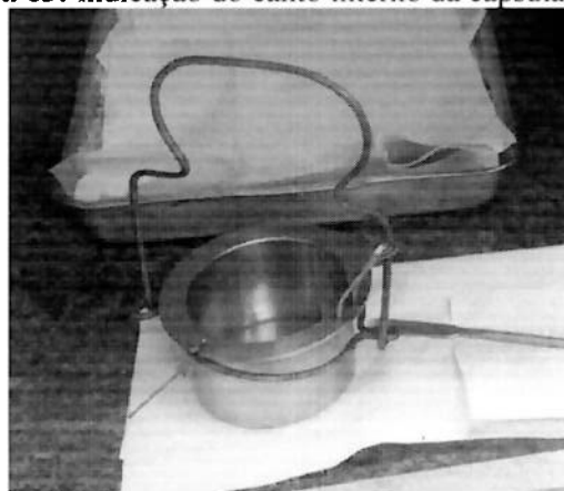
Figura 63: Indicação do canto interno da cápsula de aço
