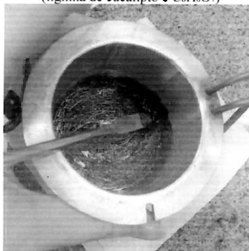
Figura 25: Fusão do composto 2 (lignina de eucalipto e C_6H_8O_7 )
