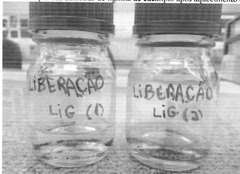
Figura 17: Diluição das amostras de lignina de eucalipto após aquecimento a 180°C
