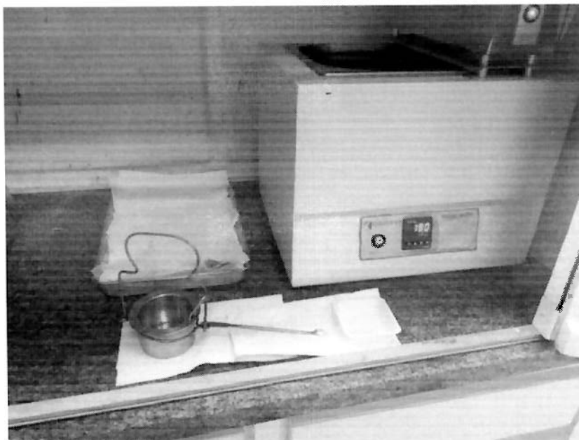
Figura 4: Cápsula de aço e aparelho para realização do banho de óleo a 180°C.
