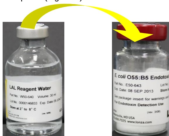
Figura A – Esquema para suspender endotoxina de E. coli utilizando água apirogênica.
