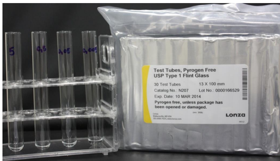
Figura B – Tubos de vidro apirogênicos necessários para diluição da endotoxina.
