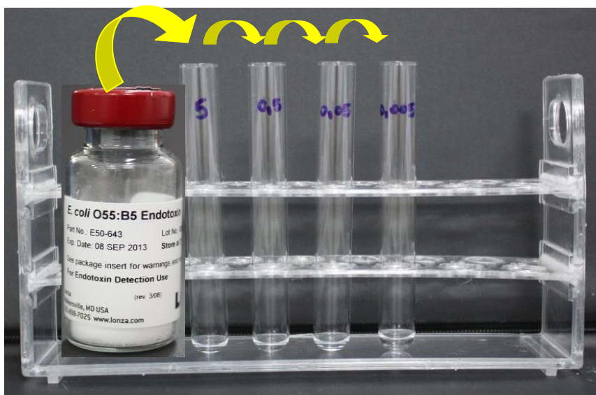
Figura C – Esquema de diluições da endotoxina para realização da curva padrão.
