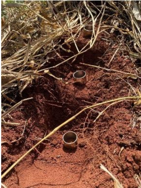
Figura 9 - Amostras indeformadas coletadas com anel de Kopeck, para determinação de densidade, macro e microporosidade e porosidade total, realizadas pelo método do anel volumétrico após semeadura da soja. Fotos: Ana Clara Britto Anacleto
