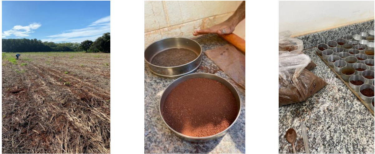
Figura 1 – Coleta do solo (a); peneiramento e preparo do solo para avaliações posteriores (b); avaliação de umidade do solo (c). Fotos: Ana Clara Britto Anacleto.
