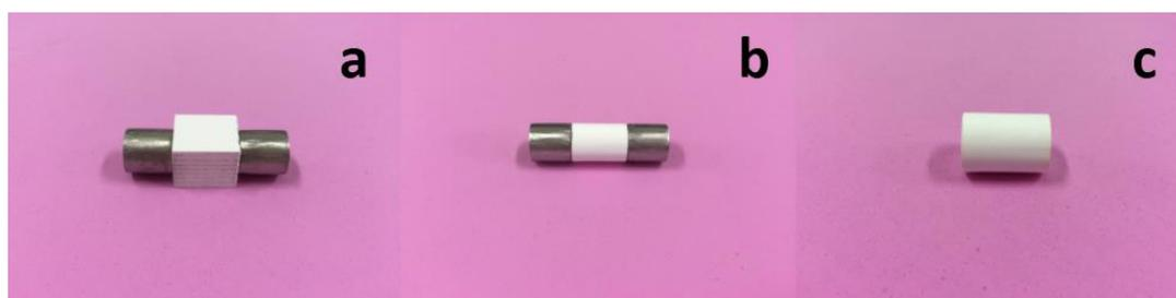
Legenda: a) bloco colado ao guia para arredondar; b) cilindro arredondado; c) cilindro pronto.
