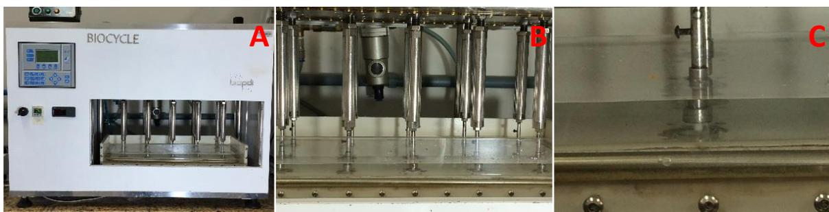
Legenda: a) máquina de ensaio mecânico, b) vista dos prolongadores e mandris, c) mandril com antagonista ajustado a amostra imersos em água.
