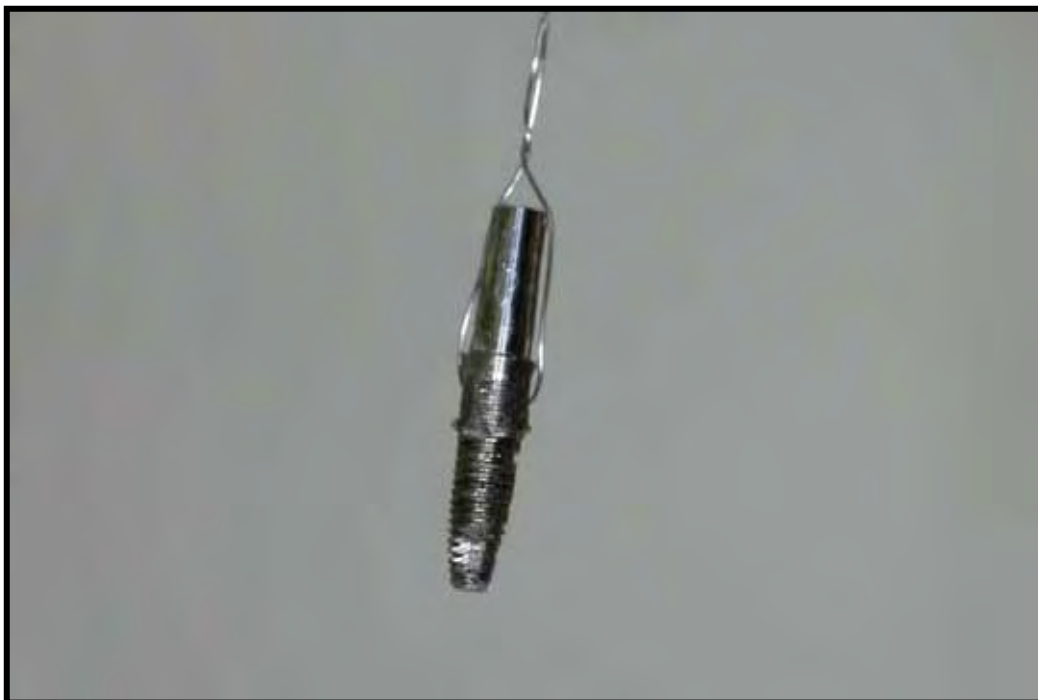
FIGURA 13 – Aspecto do conjunto implante e pilar de hexágono externo logo após a remoção da placa, estabilizado no dispositivo metálico.
