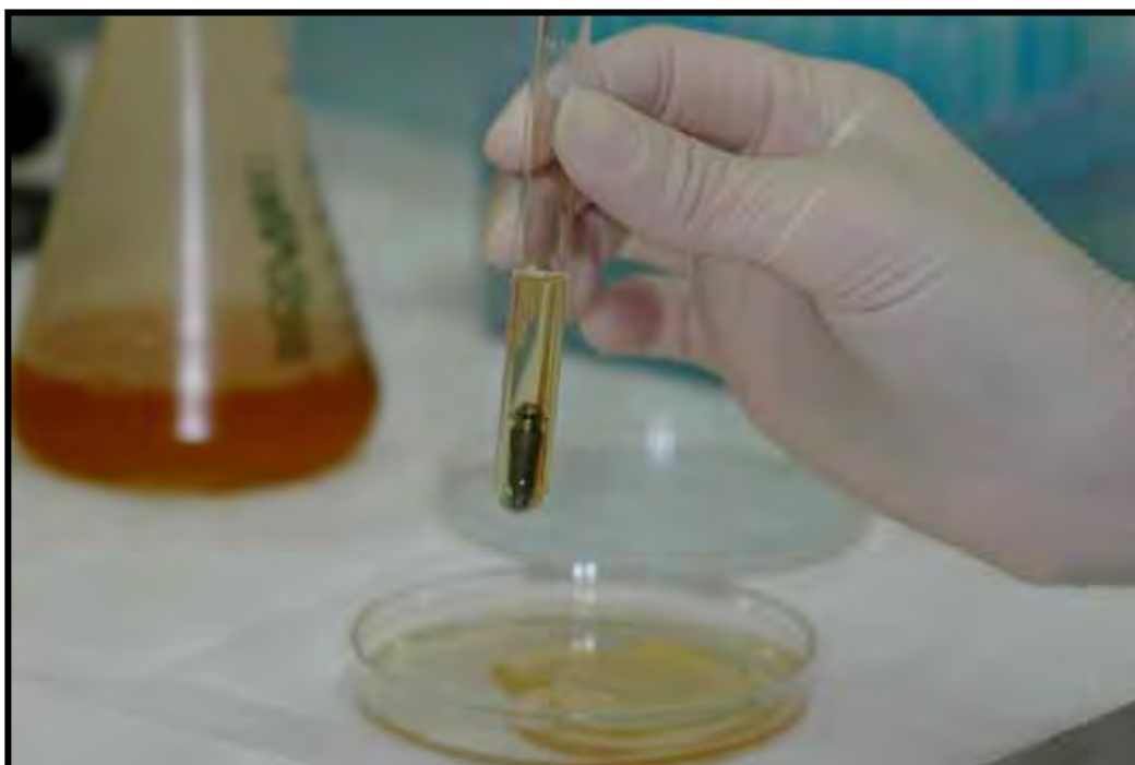
FIGURA 10 – Imersão do conjunto em tubo contendo caldo TSB.
