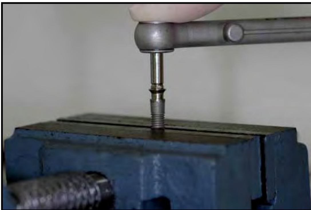
FIGURA 7 – Adaptação da respectiva chave e torquímetro.
