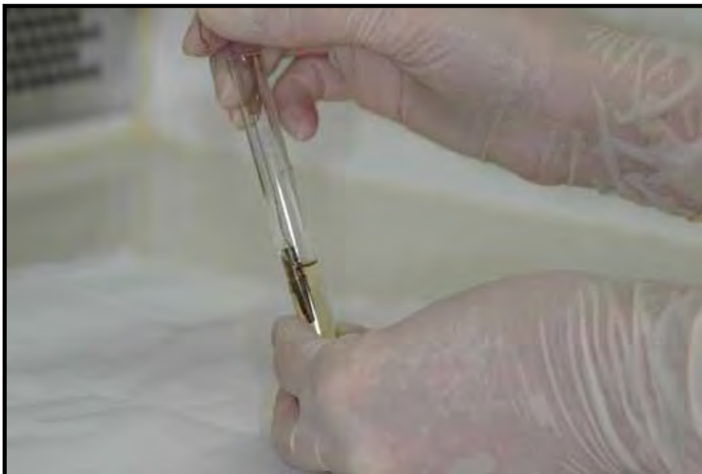
FIGURA 14 – Imersão do conjunto em tubo contendo caldo TSB sendo mantido parcialmente imerso.
