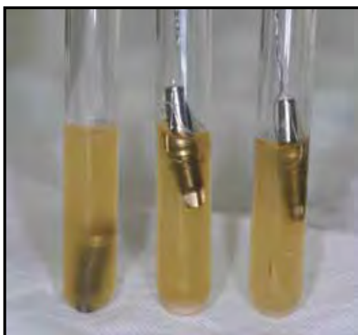
FIGURA 16 - Diferentes espécimes que apresentaram turvação do meio de cultura, indicando ocorrência de infiltração bacteriana.
