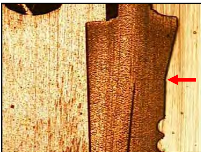
FIGURA 18 - Conexão em hexágono interno indexado (largura da fenda na interface implante/pilar = 1,9\mu\text{m} . Fotografia ao microscópio óptico (63 X).
