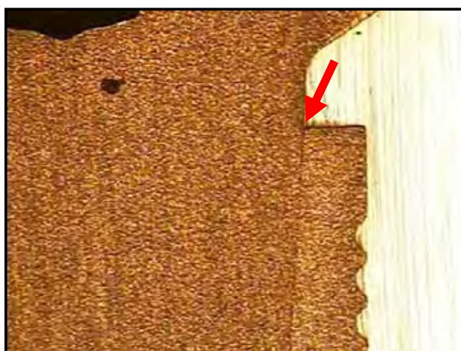
FIGURA 19 - Conexão em cone Morse (largura da fenda na interface implante/pilar = 0,4\mu\text{m} . Fotografia ao microscópio óptico (63 X).
