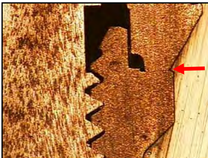
FIGURA 17 - Conexão em hexágono externo (largura da fenda na interface implante/pilar = 1,4\mu\text{m} . Fotografia ao microscópio óptico (63 X).
