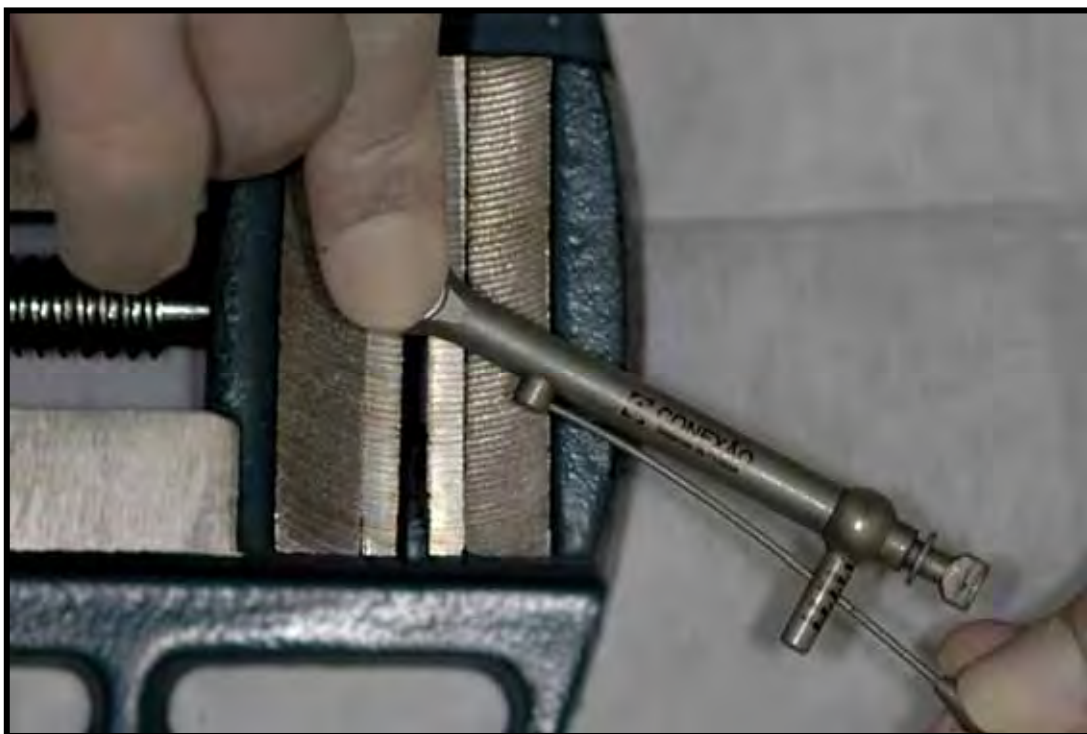
FIGURA 8 – Aplicação do torque de 20 Ncm durante 5 segundos.
