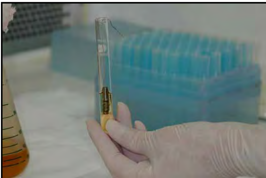
FIGURA 12 – Imersão do conjunto estabilizado no tubo de ensaio.
