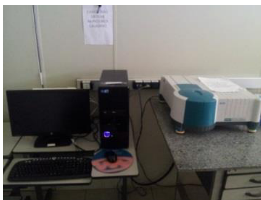
Figura 8: Espectrofotômetro de absorção óptica utilizado para realização das medidas das bandas de absorção. Fonte: imagem própria.
