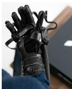
Luva de dados desenvolvida pela Haptx para interação em ambiente de RV
