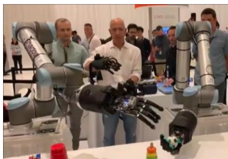
Luva de dados desenvolvida pela Haptx para controle de braços robóticos
