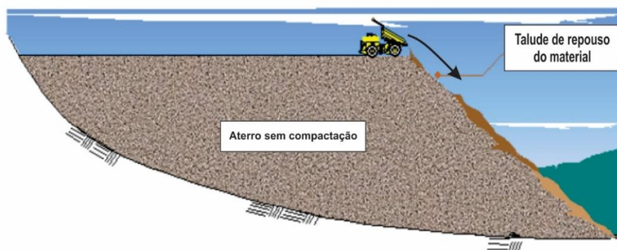
Figura 9 - Desenho esquemático da construção por ponta de aterro.
