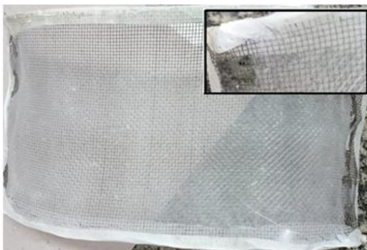
Figura 27 – Fina manta polimérica referente a amostra P5-50 depositada sobre uma tela de aço usada como anteparo sobre o coletor.
