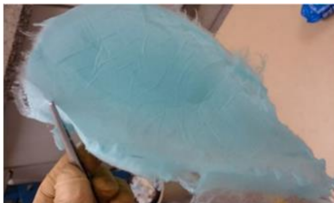
Figura 31 – Manta no estado verde referente a amostra Y10-11B, com 10% de PVP e razão Ac:PVP = 1:1 injetada a uma taxa de 100 \mu L/min.
