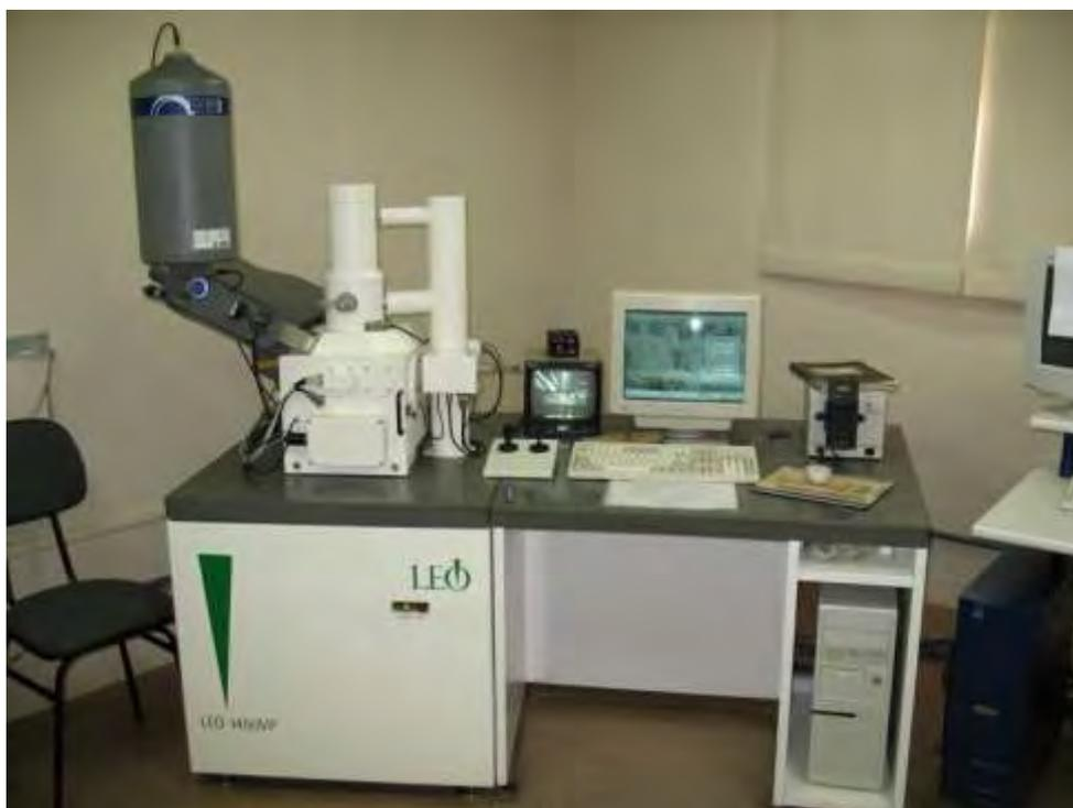
Figura 4.20 – Microscópio eletrônico de varredura empregado para análise da superfície dos braquetes
