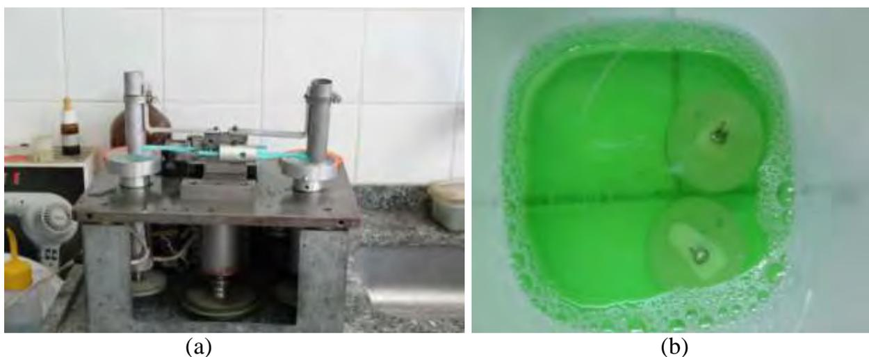
Figura 4.16 - (a) Máquina empregada para a escovação dos braquetes; (b) detalhe da vista superior das amostras dentro do pote plástico contendo flúor
