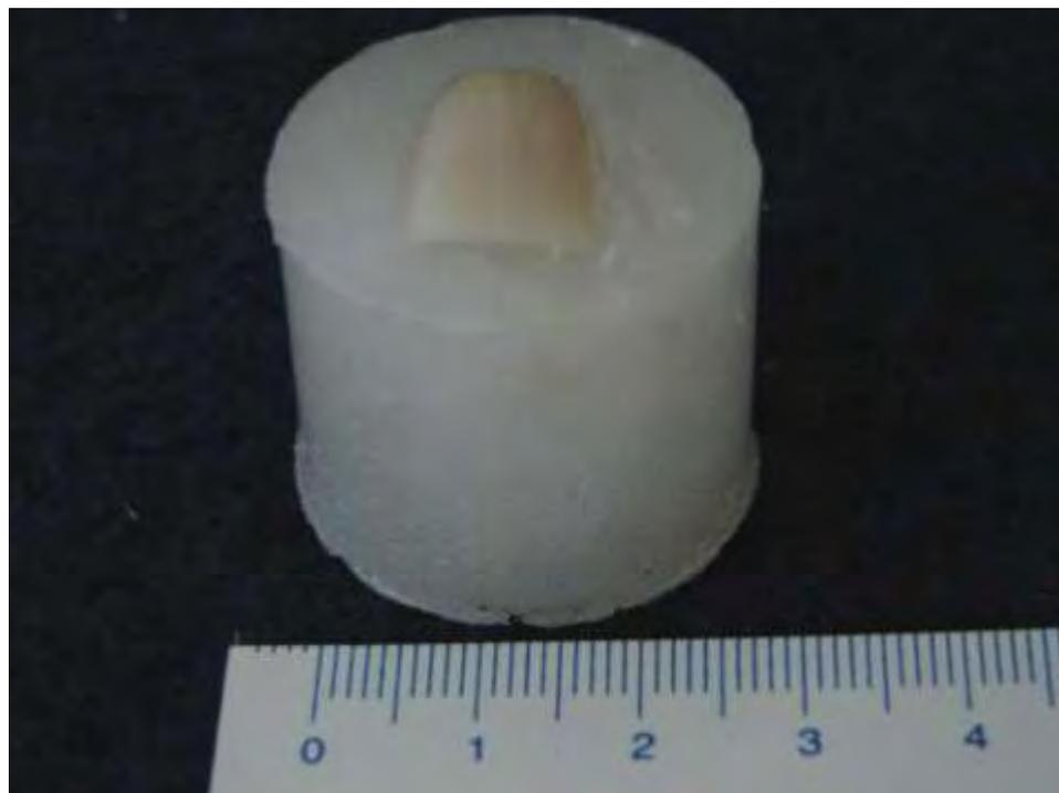
Figura 4.9 - Dente bovino incluído em resina com face vestibular centralizada (1 mm para fora da resina)
