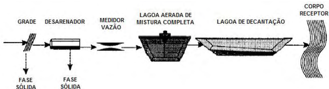
Figura 11. Desenho esquemático de uma lagoa aerada de mistura completa seguida de uma lagoa de decantação. Fonte: Von Sperling (1996).
