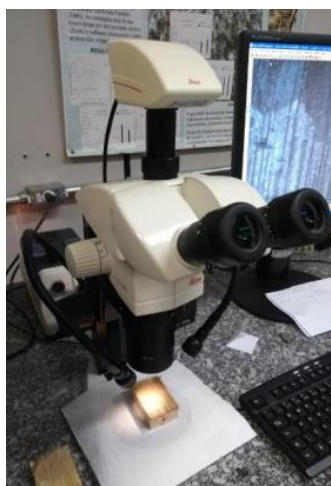
Figura 25 - Microscópio ótico LEICA M80 com iluminação.
