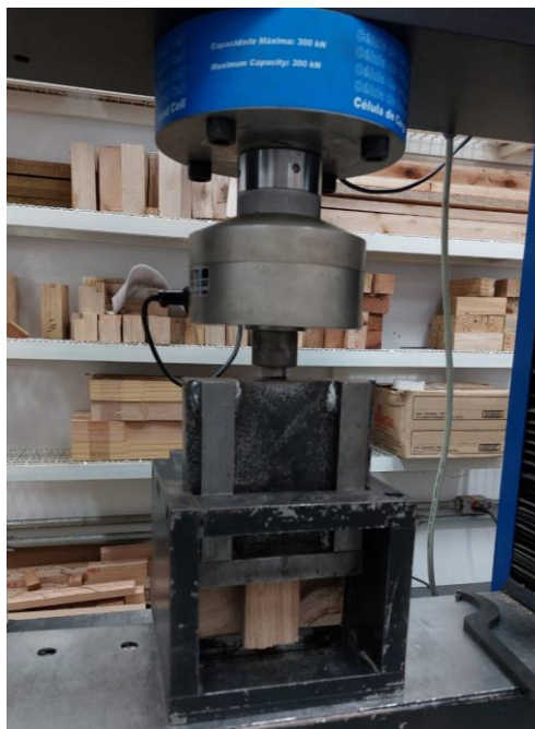
Figura 31 - Ensaio de resistência ao cisalhamento na linha de cola (lamelas de diferentes espessuras)
