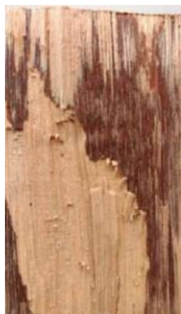
Figura 23 – Exemplo de imagem capturada referente à uma superfície de ruptura do corpo de prova rompido após o ensaio de cisalhamento da linha de cola.
