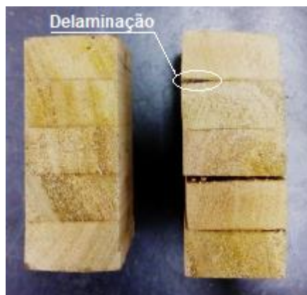
Figura 34 - Resultados dos ensaios de delaminação para os ensaios com madeiras de eucalipto e adesivo Cascophen RS 216-M.
