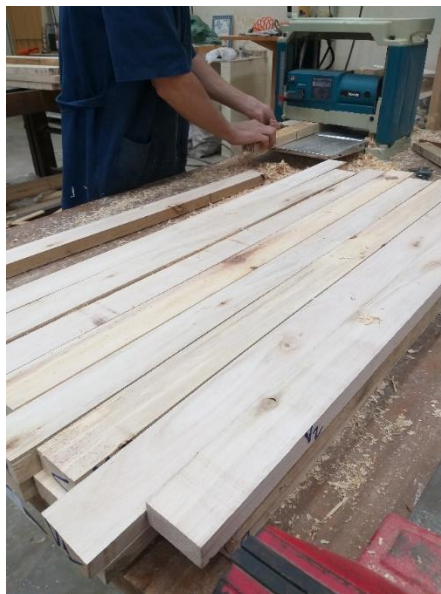
Figura 29 - Regularização da superfície da lamela.
