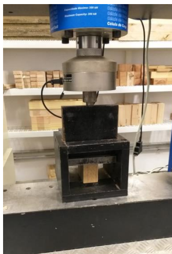
Figura 21 – Ensaio de cisalhamento na linha de cola.
