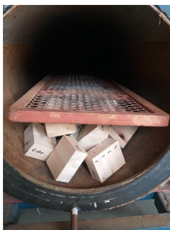
Figura 20 – Corpos de prova inseridos na autoclave para ensaio de delaminação.
