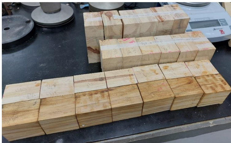
Figura 30 - Corpos de prova para cisalhamento na linha de cola
