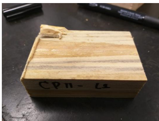
Figura 48 - Modo de ruptura mais comum na região colagem após abertura da amostra ensaiada com formão - Eucalipto colado com adesivo natural.
