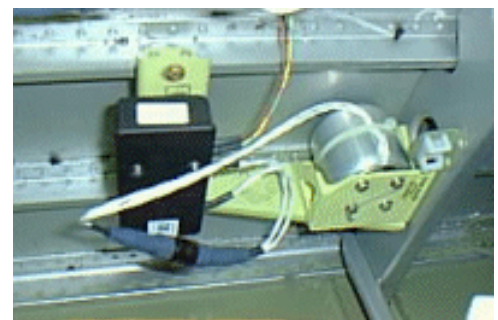
(b) Controlador ativo fixado a fuselagem
