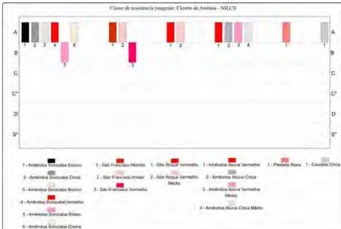
Figura 60. Avaliação (cl. de resistência) aos ataques dos reagentes utilizadas no ensaio de envelhecimento acelerado das rochas granitóides(Tipos 1 a 17)
