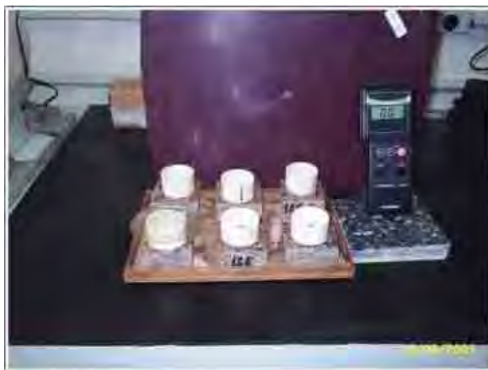
Figura 46. Ensaio que simula a alterabilidade induzida pelos processos naturais antropogênicos e de degradação sobre granitos. No lado direito vemos o aparelho Gloss Meter usado para medir perda de brilho.
