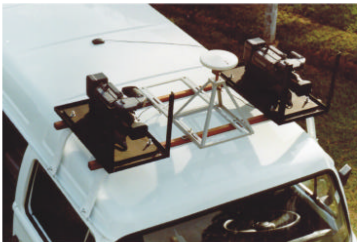
Figura 3 - Par de vídeo câmaras e antena GPS instalados na UMMD
