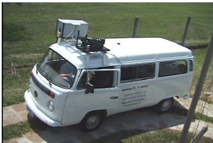
Figura 1 - Unidade Móvel de Mapeamento Digital
